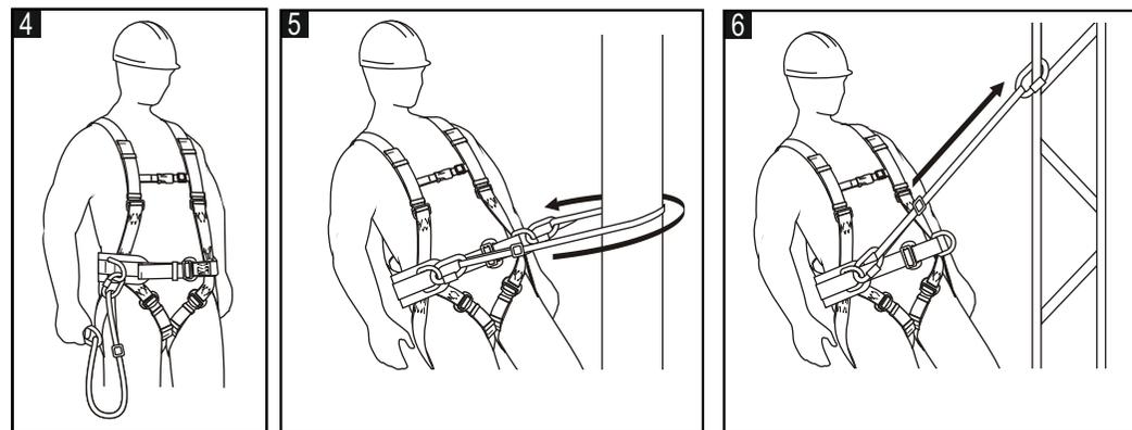
Форма и строение стационарной конструкции должны исключать возможность самопроизвольного сползания и отсоединения устройства (рис. 7).
