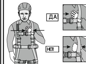
**Рис. 5. Способы надевания привязи**
