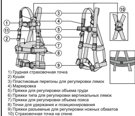
**Рис. 2. Типы крепежных точек**
