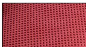
Кушак и накладки выполнены из композитного материала с внешней поверхностью из износостойкой ткани и внутренней поверхностью из влагоотводящей 3D сетки.
