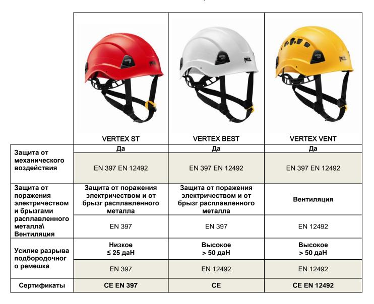
Каска VERTEX BEST не имеет сертификата CE EN 397 т.к. имеет более прочный подбородочный ремень, для снижения риска потерять каску во время падения. Каска VERTEX BEST не имеет сертификата CE EN 12492 т.к. для обеспечения защиты от поражения электрическим током и защиты от брызг расплавленного метала, на нем отсутствуют вентиляционные отверстия.
