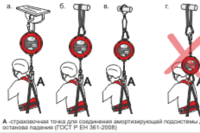
Рис. 5. Общие принципы использования карабинов
